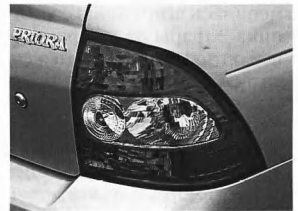
Габаритные огни и стоп-сигналы "Лады-Приоры"
